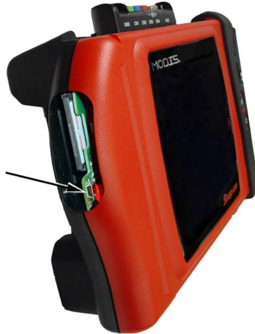
Abbildung 2-3 Position des MODIS USB-Anschlusses (Beispiel)
