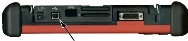
Abbildung 2-4 Position des SOLUS USB-Anschlusses (Beispiel)
