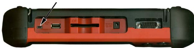
Abbildung 2-5 Position des SOLUS PRO USB-Anschlusses (Beispiel)
