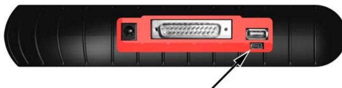
Abbildung 2-2 Position des ETHOS USB-Anschlusses (Beispiel)
