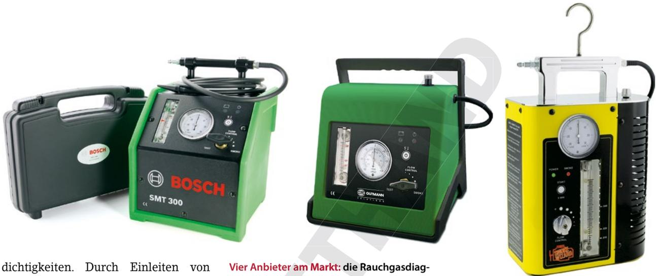
dichtigkeiten. Durch Einleiten von hochdichtem Rauch mit Hilfe eines Rauchgasdiagnosegeräts und dem Einsatz einer UV-Lampe werden für den Mechatroniker undichte Stellen sichtbar, und eine gezielte Reparatur ist möglich. Damit kann er Haarrisse und Risse in luftführenden Bauteilen wie Ansaugtrakt, Ladesystem oder Abgasystem feststellen. Auch versteckte Undichtigkeiten an der Karosserie werden
